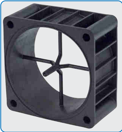
Speicherzwischenstück aus langglasverstärktem PA. Ersetzt Alu-Druckgussteil.
