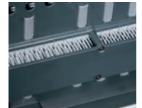
Flexibel nutzbare Bürstentypenhalter bis Ø 15 mm Flexibly usable brush-type holders for tools of up to Ø 15 mm
