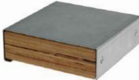
Buche Multiplex - Arbeitsplatte mit Abdeckung Für KFZ-Werkstätten, Lackierereien und Schweißarbeiten ■ Mit 1,5 mm verzinkter Stahlabdeckung, Als L-Profil verschraubt
