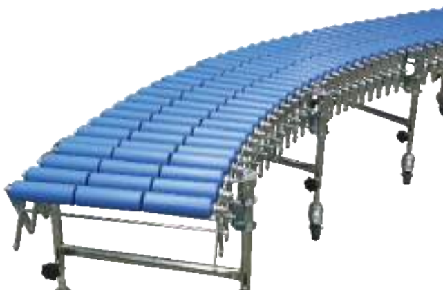
Scherenbahn mit Tragrollen aus blauem Kunststoffrohr
