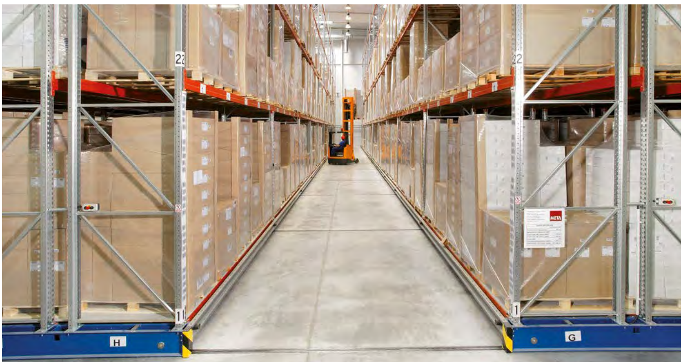
Ohne Syncon – Schiefstellung der Fahrwagen
