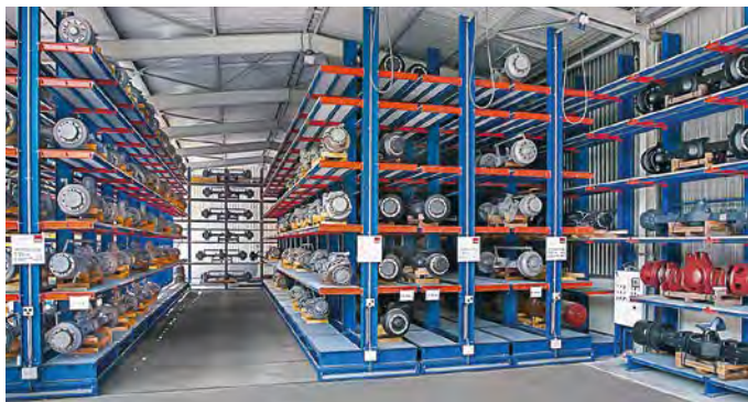
Verschieberegalanlage Steigerung der Lagerkapazität um 110% = 21 Regalzeilen
