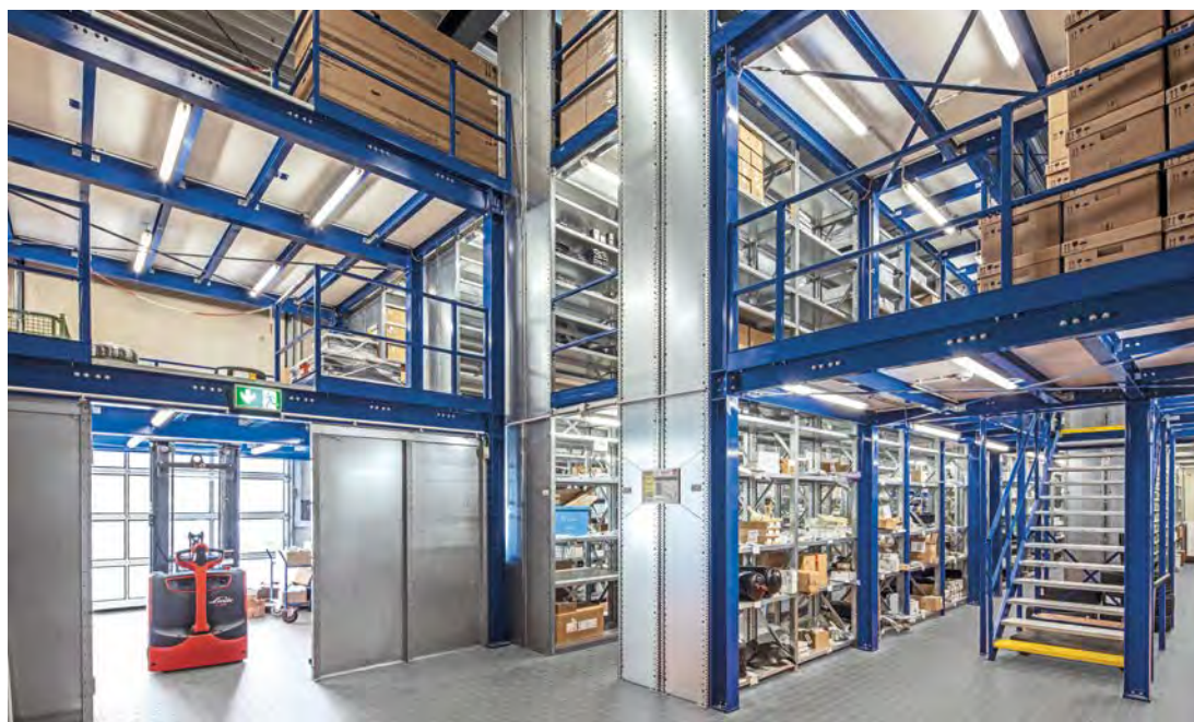
Fachboden-Geschossanlage (Seite 200 und unten) und als Fachboden-Hochregal oben rechts als Zeichnung
