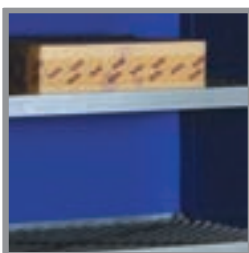
Schaumstoffmatten und Gummiseile sichern empfindliches Ladegut
