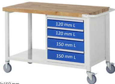
4 x Schublade-L 2x120, 2x150 mm 1 x Stahlblech-Ablageboden Höhe 40 mm- Tiefe 650 mm- Fachhöhe 580 mm (unabhängig von der Werkbanktiefe ist der Ablageboden immer hinten bündig mit dem Gestell)
