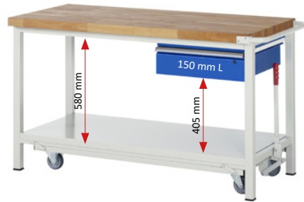
1 x Schublade-L 1x150 mm (Tragkraft 50 kg) Stahlblech-Ablageboden Höhe 40 mm - Tiefe 650 mm - Fachhöhe 405/580 mm
