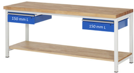
2 x Schublade-L 2x150 mm (Tragkraft 50 kg) Buche-Massiv-Ablageboden Stärke 25 mm- Tiefe 557 / 757 mm- Fachhöhe 420/595 mm
