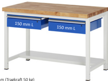
2 x Schublade-L 1x150 mm (Tragkraft 50 kg) Stahlblech-Ablageboden Höhe 40 mm- Tiefe 320 mm- Fachhöhe 445/620 mm (unabhängig von der Werkbanktiefe ist der Ablageboden immer hinten bündig mit dem Gestell)
