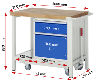
1 x Schublade-L 1x180 mm, 1 x Flügeltür-L 1x360 mm Stahlblech-Ablageboden Höhe 40 mm- Tiefe 650 mm- Fachhöhe 620 mm
