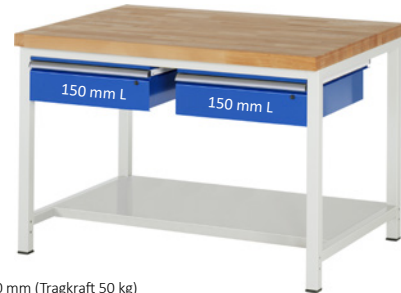
2 x Schublade-L 1x150 mm (Tragkraft 50 kg) Stahlblech-Ablageboden Höhe 40 mm- Tiefe 650 mm- Fachhöhe 445/620 mm (unabhängig von der Werkbanktiefe ist der Ablageboden immer hinten bündig mit dem Gestell)
